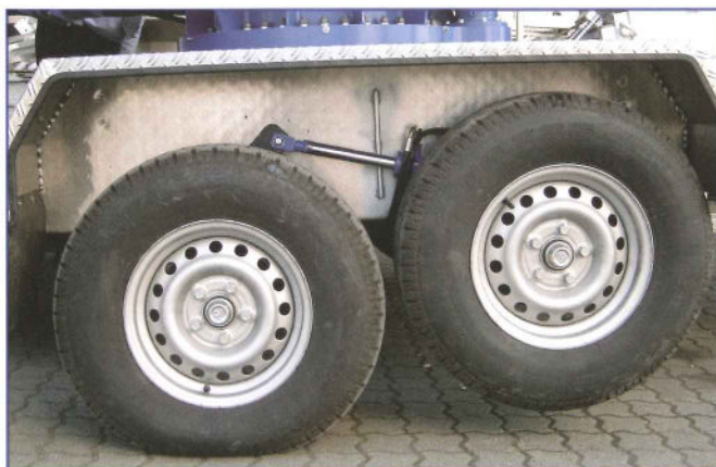
Facilité de manipulation grâce à l'essieu rétractable.
