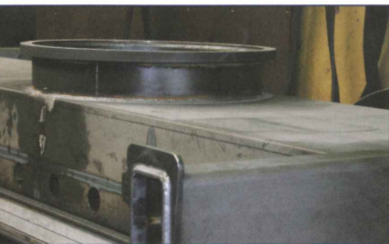
Châssis en acier pour réduire au minimum les torsions.
